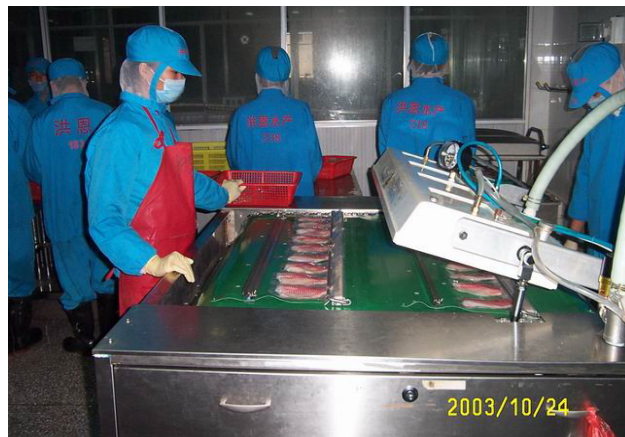
Figura 4.5 Empaque al vacío de filetes individuales en la industria de la tilapia en China.
